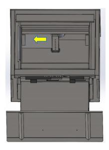
3. THEN MOVE SIDEWAYS UNTIL SUPPORTED BY THE SUPPORT PLATE AND TOUCHING THE SIDE WALL. MAKE SURE THE BAFFLE PLATE ALSO TOUCHES THE REAR WALL.
