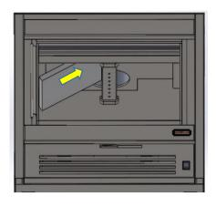
2. CERAMIC BAFFLE PLATES SIZE 230mmX240mm. INSTALL THE BAFFLE PLATE 230mm FRONT TO BACK, 240mm SIDE TO SIDE. GET BAFFLE PLATE INSIDE THE FIREBOX AND TILT ON AN ANGLE. PUSH BAFFLE PLATE OVER THE AIR TUBE
